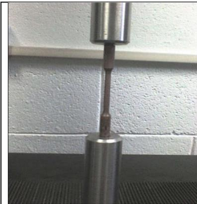
Una prueba de laboratorio consiste en aplicar sobre una probeta normalizada un esfuerzo axial de tracción (alargamiento) hasta producir una ruptura.
