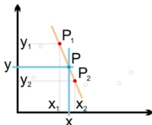
En la figura se puede apreciar un tipo de interpolación, llamada *lineal* en la cual se aprecia que dado un valor de  $x$ , se pretende encontrar su correspondiente valor de  $y$ .
